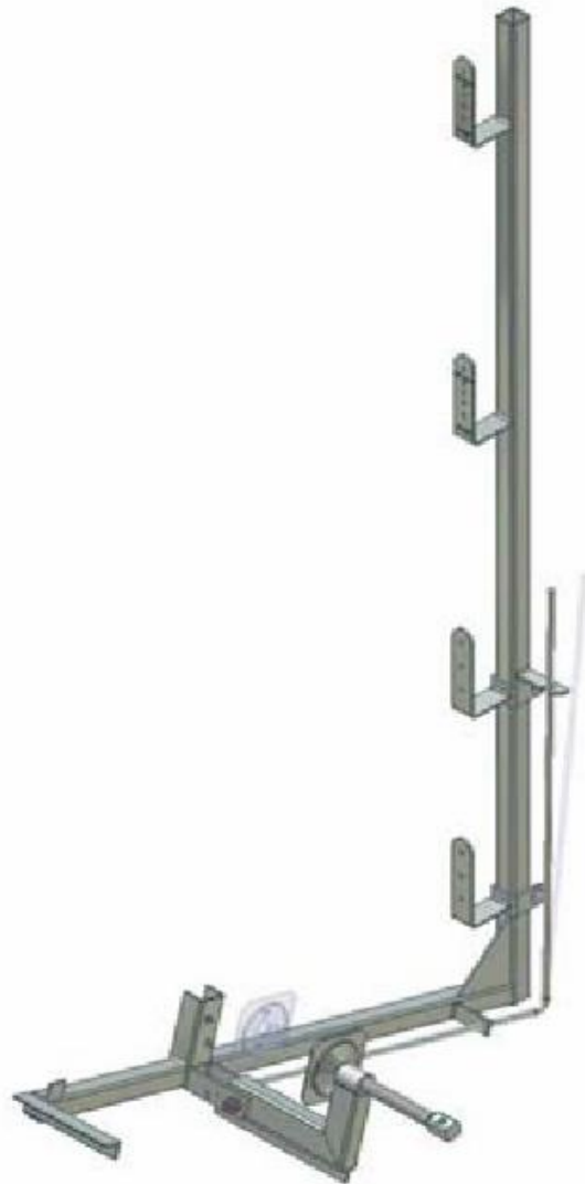
Parapetto provvisorio per elementi strutturali in legno – fissaggio frontale
