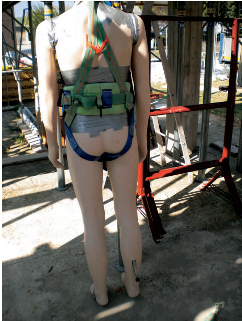
Figura 37 – Manichino appeso al sistema anticaduta dopo la caduta nella prova in mezzeria
