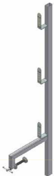
Parapetto provvisorio ammortato con ganascia fissa
