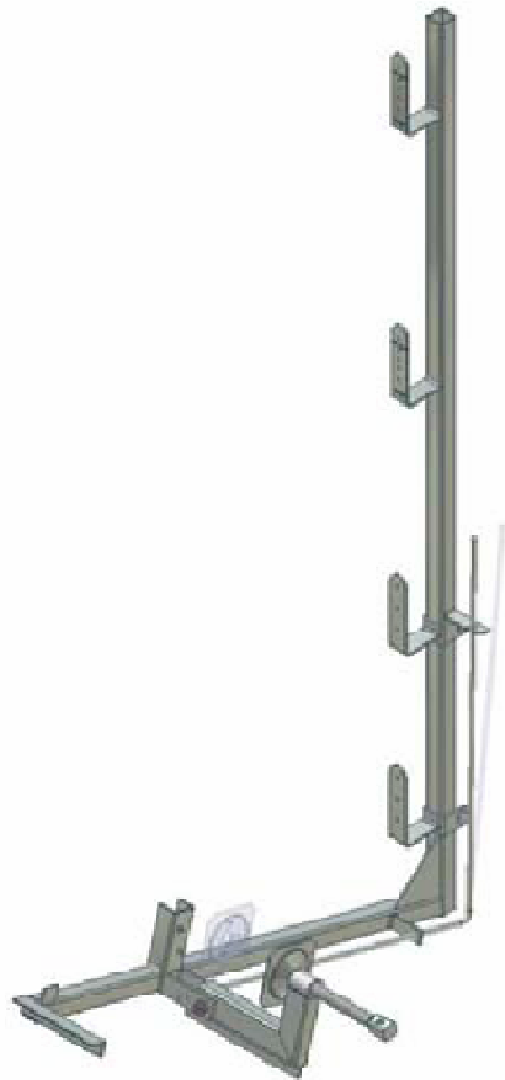
Parapetto provvisorio per elementi strutturali in legno - fissaggio frontale
